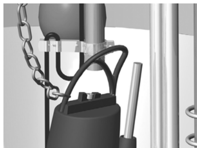
Fig. 8 Kätting fäst på pumpen
